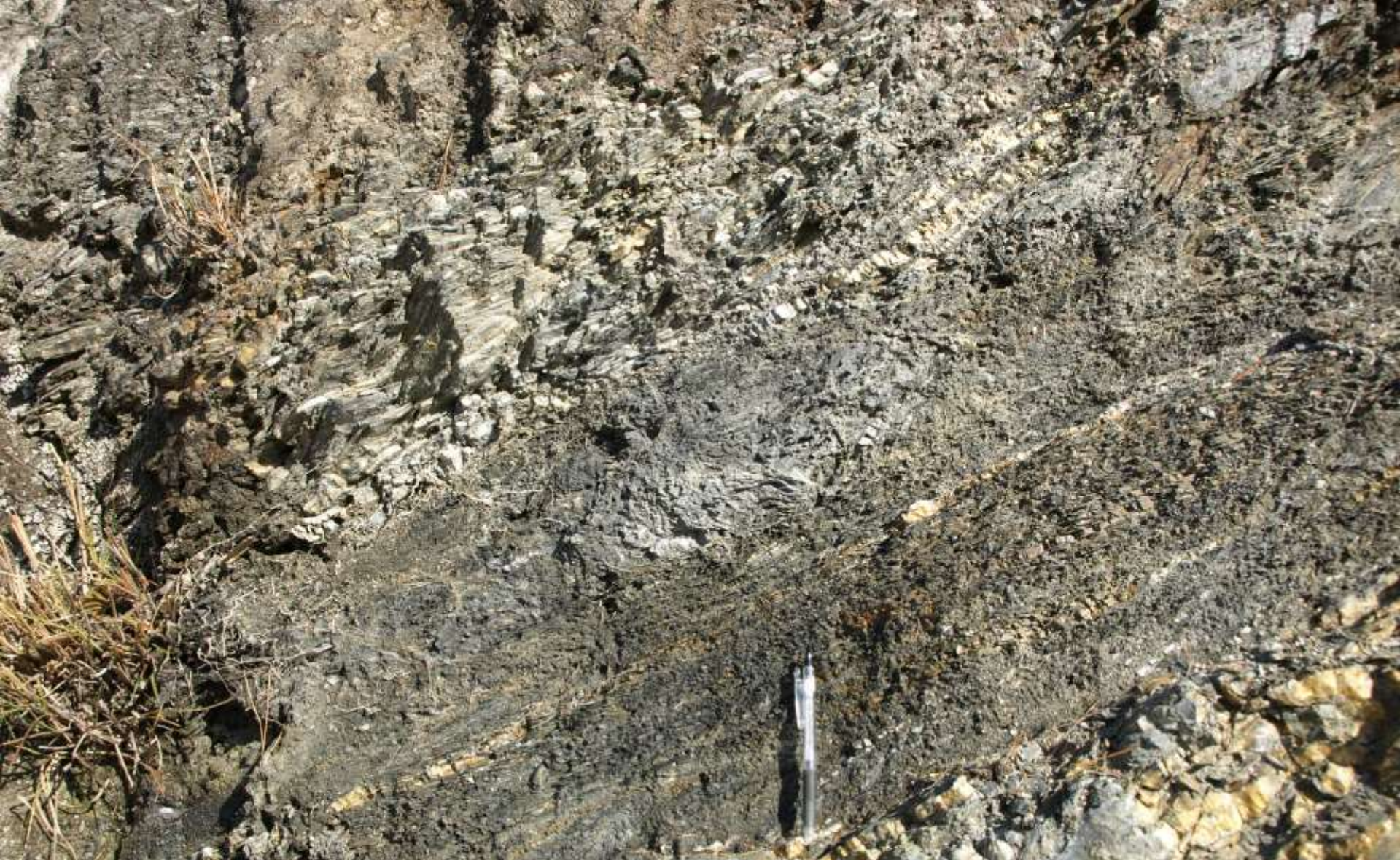
三波川変成岩の写真 （徳島市大原）. 右上から左下に延びる縞々が明瞭（＝片理面）. これに沿って地すべりが起こりやすい.
