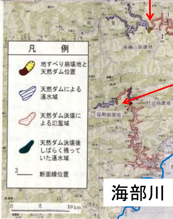
図一2 高嶺山と保勢・杖追の天然ダムと決壊後の洪水範囲 Fig. 2 Flood area of outburst in Takaisoyama and Hose, Tunesako
