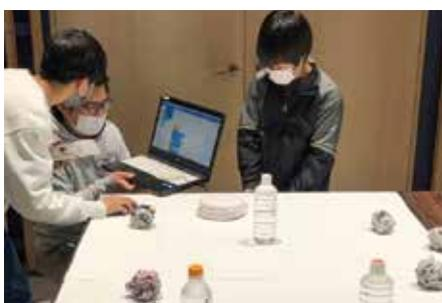
▲作成したプログラム通りに、障害物に当たると回転して方向を変え、落ちそうになると後ろに下がるおそうじロボット。
